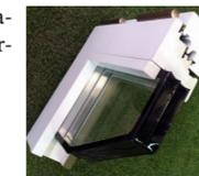
Acristalameinto doble con cámara de aire 3+3,12,4+4 con recubrimiento bajo emisivo en la cara interior del vidrio.
